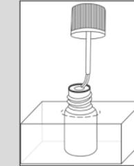
Kunststoffrohr. Der Einsatz sorgt dafür, dass überschüssige Flüssigkeit abgestreift wird.
